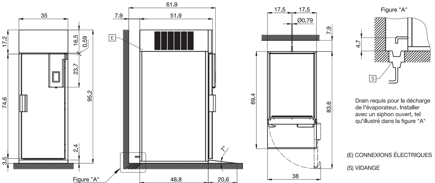
Drain requis pour la décharge de l'évaporateur. Installer avec un siphon ouvert, tel qu'illustré dans la figure "A"
